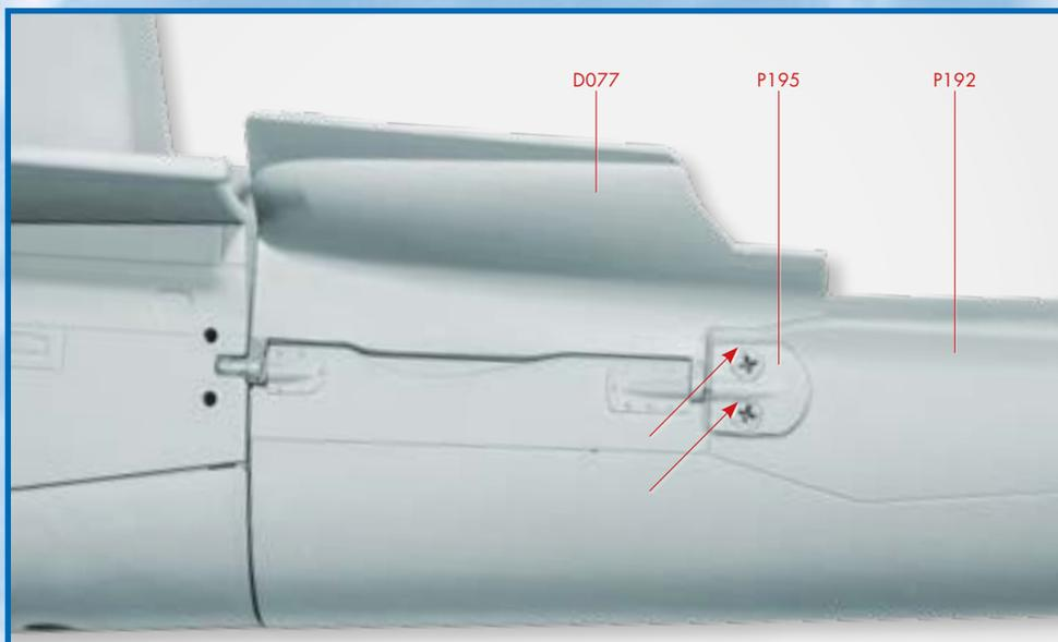
**3** Установите фиксирующую пластину (P196), как показано на снимке. Закрепите пластину двумя винтами МР. При закручивании винтов не прилагайте особых усилий, чтобы избежать повреждения деталей и винтов.
